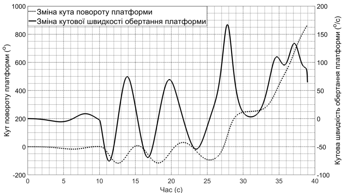
Рис. 4. Зміни кута повороту платформи та кутової швидкості її обертання за час польоту ЛА типу 2
