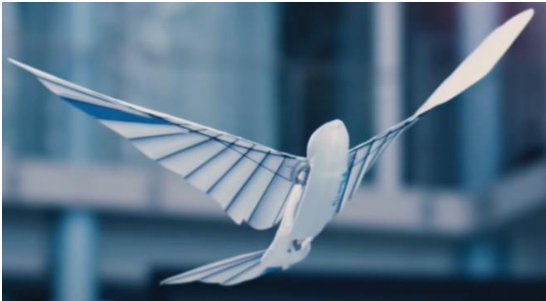
Рис. 2. Орнітоптер із 2-а степенями вільності
