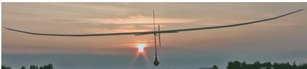
Рис. 1. Орнітоптер із 4-а степенями вільності
