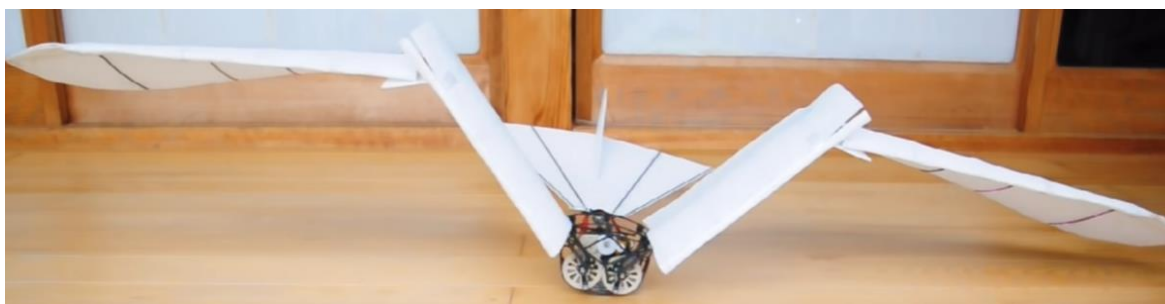
Рис. 3. Орнітоптер із 3-а степенями вільності
