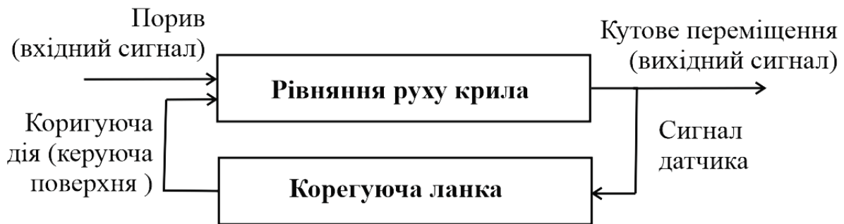
Рис. 4. Блок-схема системи керування аеропружністю
