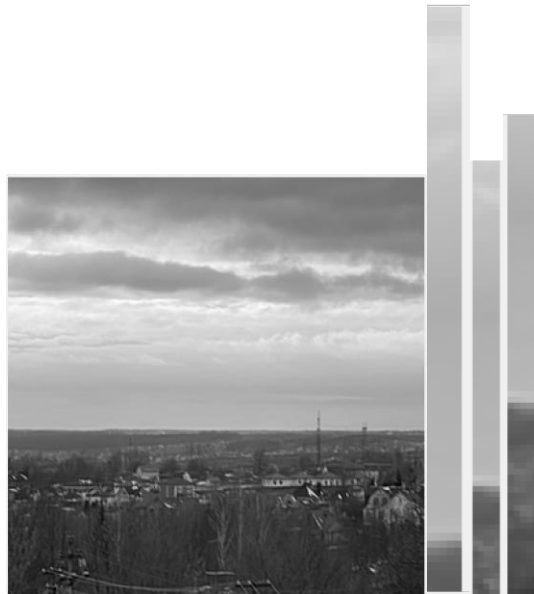
Рис. 1. Приклади поточного зображення та вирізаної смуги після компенсації кутів крену та рискання
